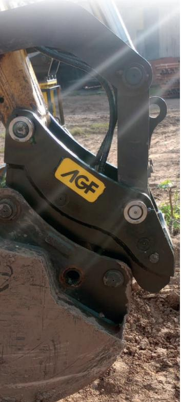
Os **Engates Rápidos AGF** foram especialmente projetados para agregar vantagem operacional às máquinas. Uma ferramenta ideal para agilizar e facilitar a troca de implementos em escavadeiras e retroescavadeiras, sendo um acessório seguro, durável e com manutenção simplificada.
