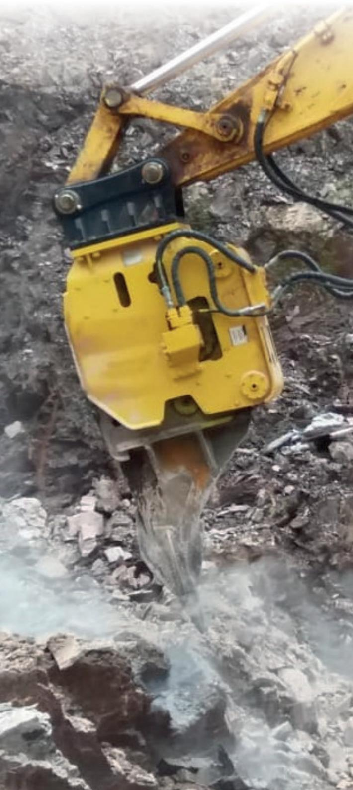
Os **Vibro Rippers** distribuídos exclusivamente pela AGF Equipamentos® são uma solução inovadora para demolição de materiais de média e baixa dureza, como calcários, saibros e pedras em decomposição.
